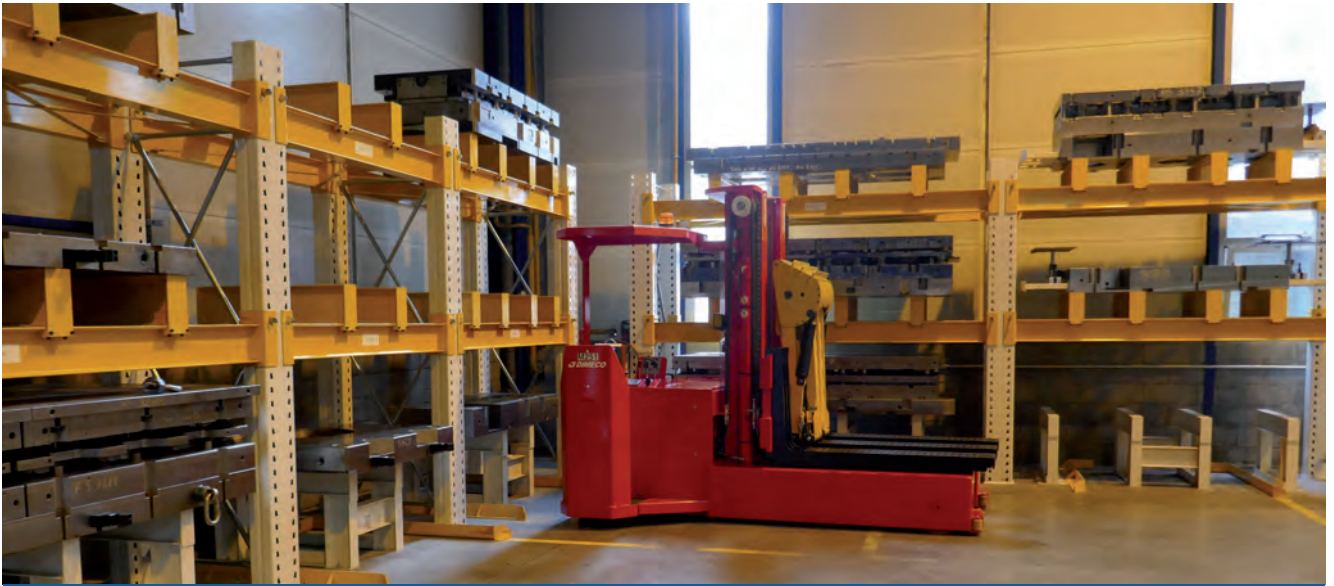
C'est l'ensemble du chariot plus le rayonnage de stockage qui permet les gains de temps lors des changements d'outils.
