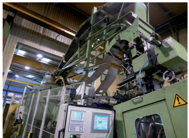
Amenage spécifique développé par Dimeco pour répondre aux besoins spécifiques de l'approvisionnement des presses utilisées par Gris Group pour le découpage des rondelles.
