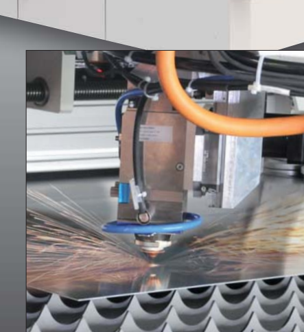
Cabeza de corte láser con desplazamiento X & Y por motores lineales y eje Z vertical por servo motor
