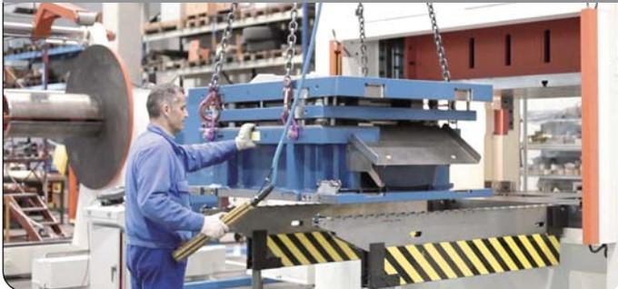
El cambio de un troquel por medio de una carretilla elevadora directamente sobre una mesa es muy peligroso. Por medio de un puente es simplemente imposible. Las consolas permiten el cambio de un troquel en el puente o con una carretilla elevadora con total seguridad. Además de ganar en seguridad, el uso de un medio adaptado permite ganar cierto tiempo. Las consolas están equipadas con rodillos para cargas pesadas
