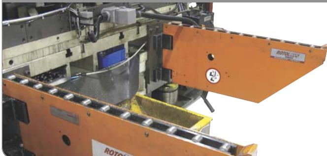
Die am Pressentisch fest installierten Konsolen ermöglichen einen erheblichen Zeitgewinn sowie eine sichere Handhabungen für die Bediener.
