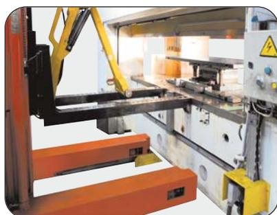
De plus, l'ensemble des mouvements du chariot est contrôlé par un automate, autorisant des actions en fonction de l'état du chariot.
