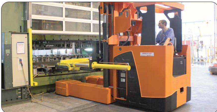
Chargement d'outil sur presse mécanique 1000 tonnes
