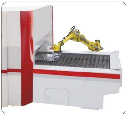
Robot 6 axes pour l'empilage
