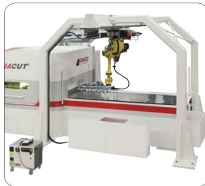
Robot 7 axes pour empilage alterné
