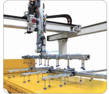
Portalroboter für komplexe Stapelaufgaben
