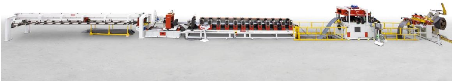
Flexipresse incorporée dans une ligne flexible pour fabrication de glissières d'autoroute.
