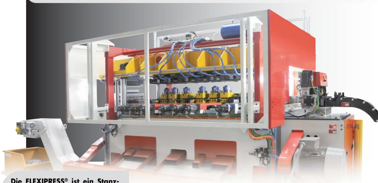
Die FLEXIPRESS® ist ein Stanzprozess aus einer mechanischen Presse, der speziell zum Stanzen und Prägen entwickelt wurde. Mit dieser Presse können hohe Taktfrequenzen und große Schlagkräfte erzeugt werden. Das Werkzeugauswahlsystem macht es zu einem wesentlichen Konzept für die Herstellung von Familienprodukten mit hohen Produktionsmengen.
