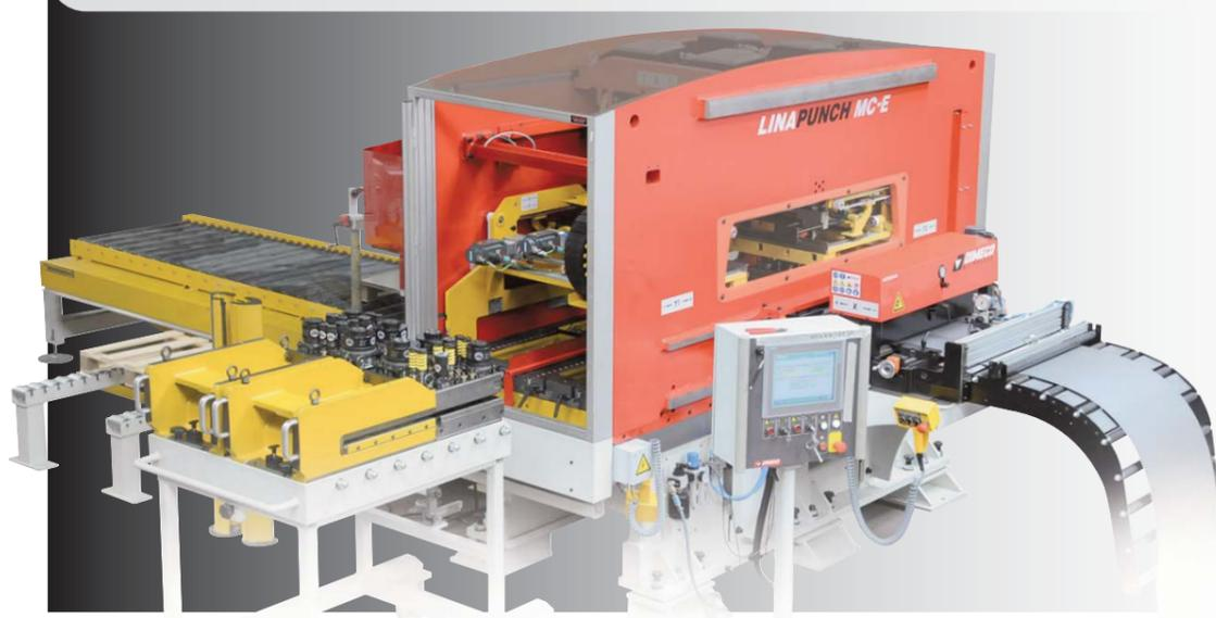
Die elektrische LINAPUNCH® ist eine mit Coil-Zuführung versehene MULTI-AXIS-Stanzmaschine, die die gleichen Standardwerkzeuge verwendet, wie die auf dem Markt erhältlichen Revolverwerkzeuge. Diese bewährte Lösung wird seit mehr als 35 Jahren von vielen Anwendern in der ganzen Welt geschätzt.
