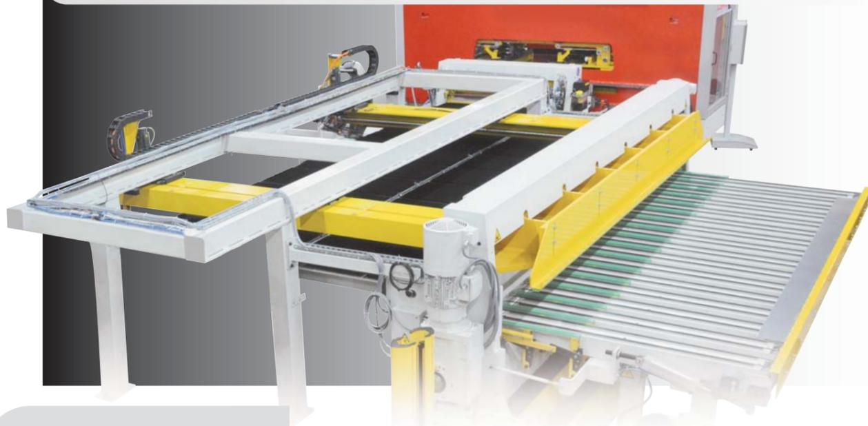
Das SCHERENZENTRUM ist integriert in die Stanzlinie oder Querteilanlage und erreicht dadurch die höchste Flexibilität und Produktivität. Es ermöglicht das Trennen der verschachtelten Teile in der Breite des Streifens durch Längsscheren.
