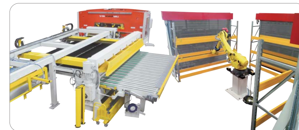
Wykrwanie i cięcie wzdłużne - Układanie za pomocą robotów
