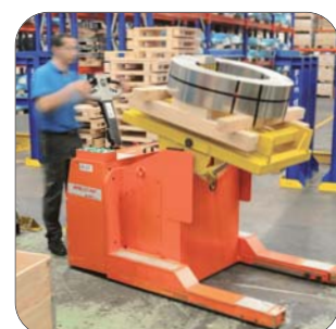
Obsługa kręgów: System Quickcoil
