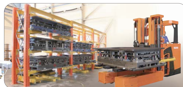
Obsługa narzędzi: System Quickblock
