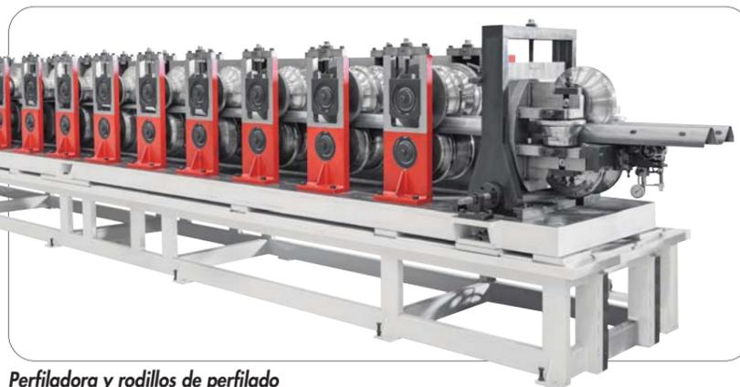
Perfiladora y rodillos de perfilado
