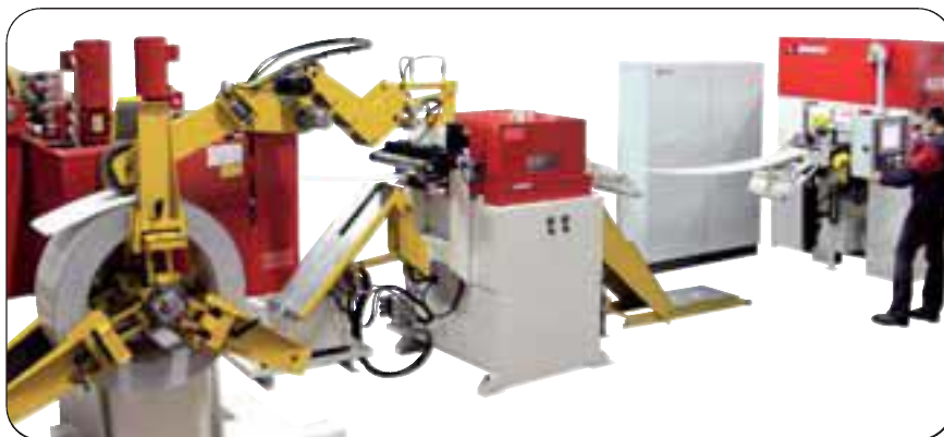
Línea de alimentación PITSTOP, inicio de una FLEXILÍNEA®
