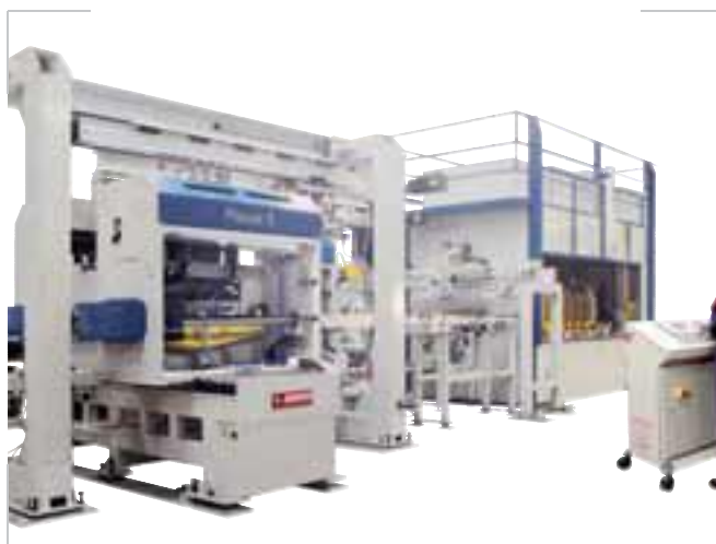
Línea de producción de armarios eléctricos
