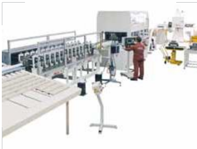
Línea de fabricación de cuerpos para fluorescentes
