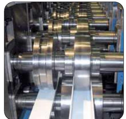
Profilage simultané de 2 pièces
