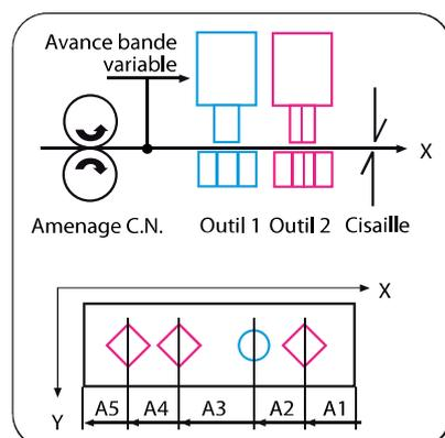
Le poinçonnage MULTIPAS : principe
