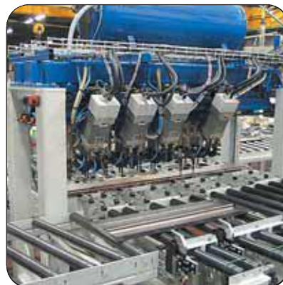
Elektrisches Schweißen von Verstärkungen
