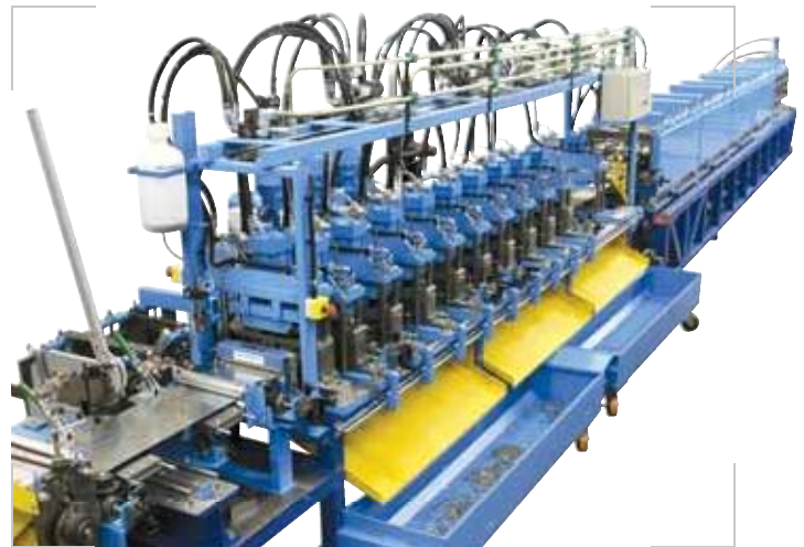
Fertigungslinie für Weinbergpfähle
