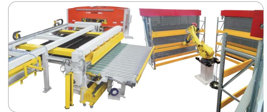
Poinçonnage et coupe longitudinale - Évacuation et stockage robotisé
