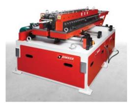
Cuando la anchura de la pieza varía, manteniendo la forma del perfile en los laterales, se utilizan perfiladoras de doble cuerpo, cuya anchura es regulable de forma manual o automática.
