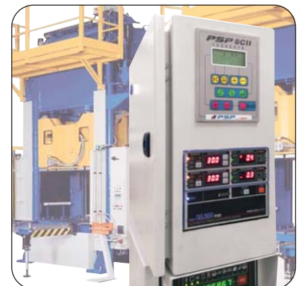
Moniteurs intégrés à l'armoire de presse
