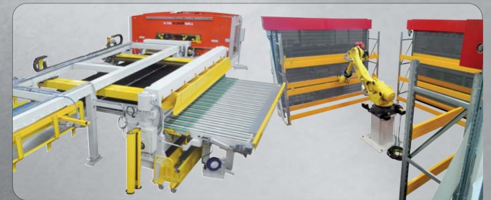
Punzonado y corte longitudinal - Evacuación y almacenaje robotizado
