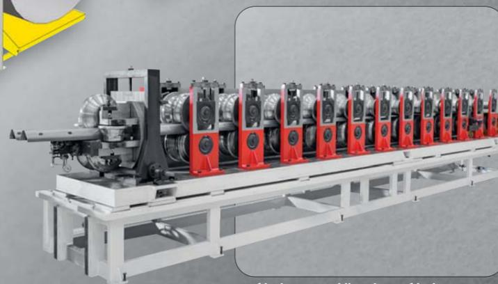
Perfiladora y rodillos de perfilado
