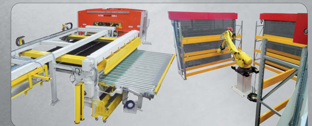
Poinçonnage et coupe longitudinale - Évacuation et stockage robotisé
