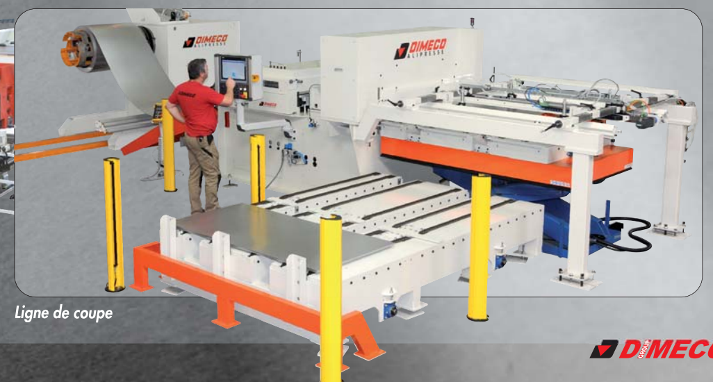
Poinçonnage et coupe longitudinale - Évacuation et stockage robotisé
