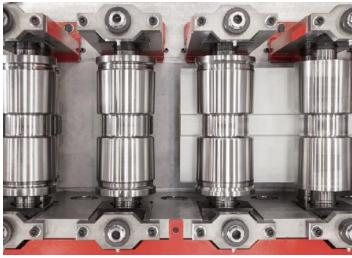
Dans notre approche au client, et dans le but de répondre aux besoins posés, DIMECO offre la possibilité de fournir les jeux de galets nécessaires à l'obtention de divers profils, dans des profileuses existantes.
